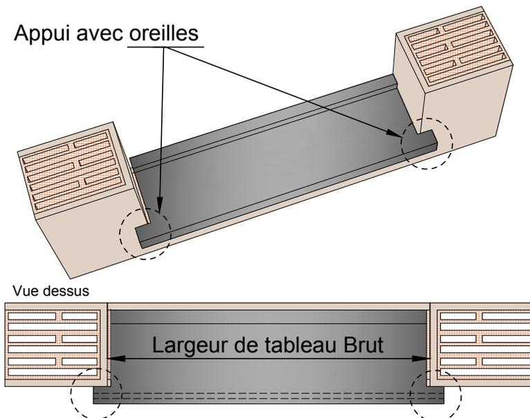
Exemple de mur en brique 220 mm
